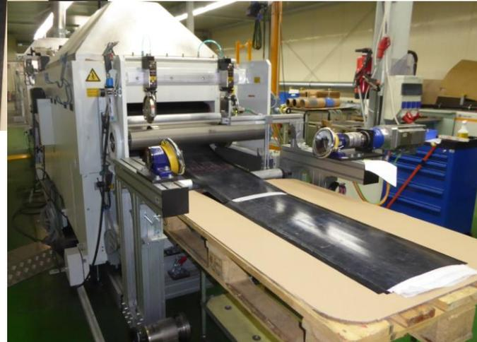
Magazinieren und Entnahme der funktionalisierten Bänder
