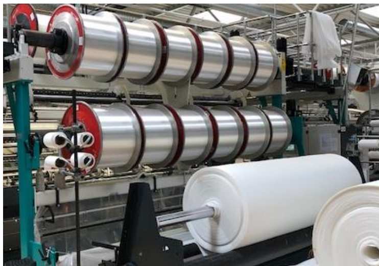
Foto: Fertigung Abstandsgewirke (Quelle: Pressless)
