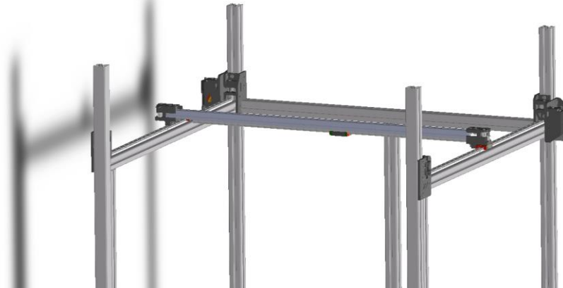
Entwurf der Kinematik der x- und y-Achse
